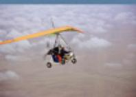
**Pendulaire :** c'est l'ULM tel que l'on se l'imagine : tout terrain, il est adapté aux pistes courtes, le chariot est suspendu sous une aile delta, sa plage de vitesse se situe entre 80 et 120 km/h suivant les caractéristiques de l'aile.
