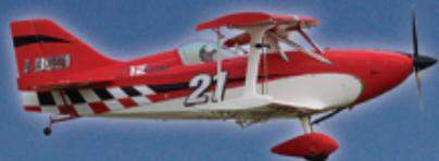
Un ULM (Ultra Léger Motorisé) est un aéronef défini par sa masse maximale (450 Kg), sa puissance et sa vitesse minimum. Il peut emporter 1 à 2 personnes suivant le modèle.
