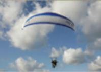
**Paramoteur :** un parapente équipé d'une sellette motorisée devient un paramoteur, il permet des déplacements aisés à vitesse réduite, idéal pour l'observation de sites.
